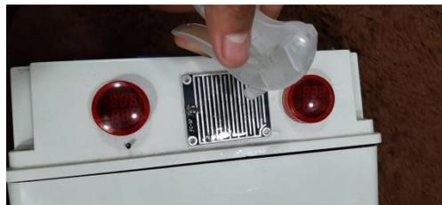
**Gambar 8. Pengujian Sensor YL-38**
