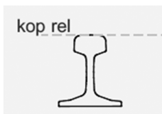
Gambar 2 Kop Rel Sumber: Buku Saku Perawatan Jalan Rel (Perjana), 2012
