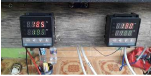
Gambar 12. Pengaturan Temperatur Pada 185°C - 190 °C
