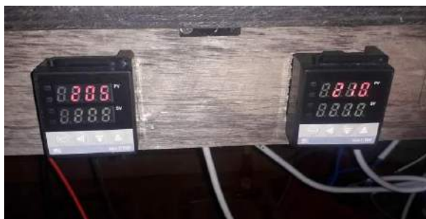
Gambar 15. Pengaturan Temperatur Pada 205°C - 210 °C
