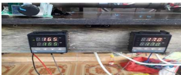
Gambar 9. Pengaturan Temperatur Pada 165°C – 170°C
