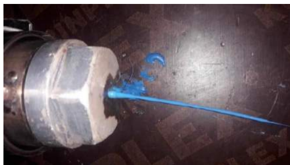
Gambar 17. Hasil Penarikan pada Temperatur 205°C - 210 °C
