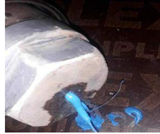
Gambar 13. Hasil Keluaran Dies pada Temperatur 185°C - 190 °C
