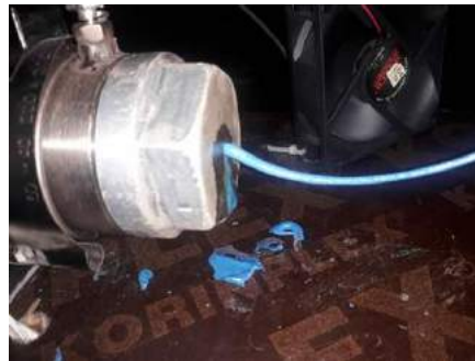
Gambar 14. Hasil Penarikan pada Temperatur 185°C - 190 °C
