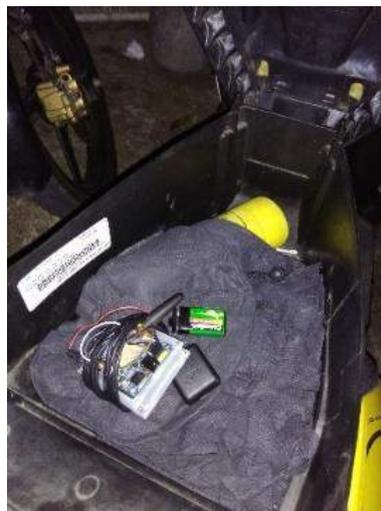
Gambar 8. Alat Pelacak disimpan pada Sepeda Motor
