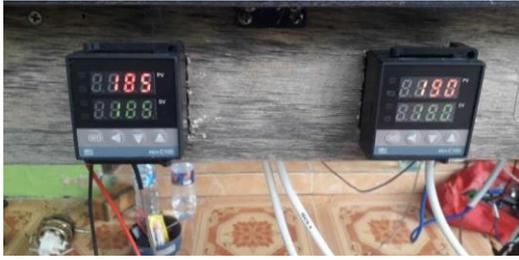
Gambar 12. Pengaturan Temperatur Pada 185°C - 190 °C
