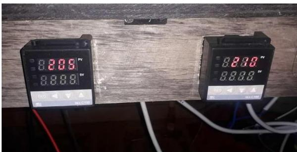
Gambar 15. Pengaturan Temperatur Pada 205°C - 210 °C
