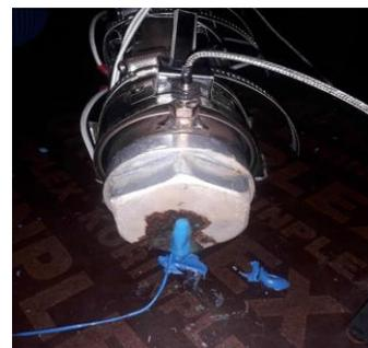
Gambar 16. Hasi Keluaran *Dies* pada Temperatur 205°C - 210 °C
