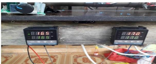
Gambar 9. Pengaturan Temperatur Pada 165°C – 170°C
