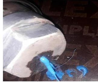
Gambar 13. Hasil Keluaran *Dies* pada Temperatur 185°C - 190 °C
