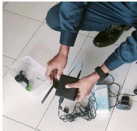
Gambar 5 Kalibrasi MPU6050 Menggunakan Busur Derajat
