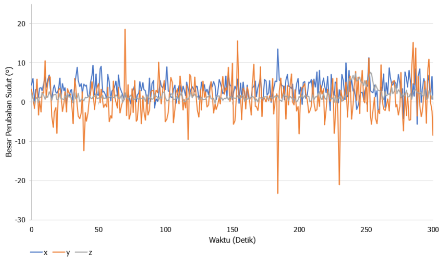
Gambar 6 Hasil Perolehan Modul MPU6050 pada Sensor Gyroscope
