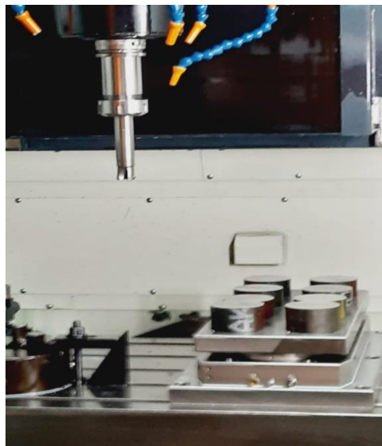
Gambar 13. Penempatan Fixture dan Benda Kerja pada Mesin CNC
