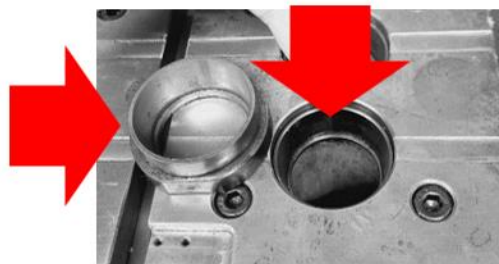
Gambar 2. Ring Inject Cavity Mould Setelah Dilakukan Proses Machining
