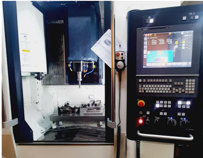
Gambar 14. Program G Code Dijalankan pada CNC Milling
