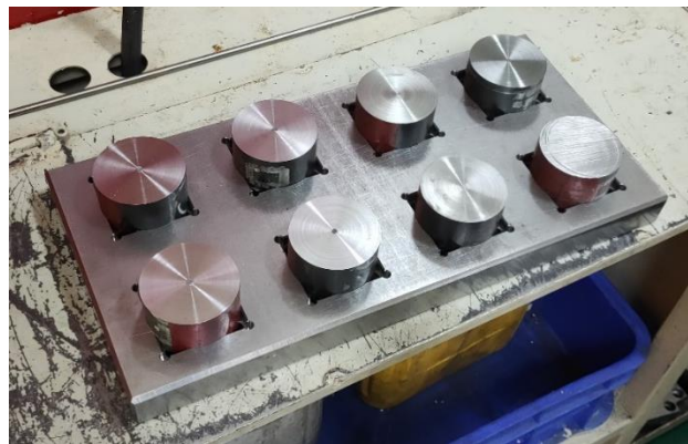
Gambar 12. Penempatan Benda Kerja pada Fixture
