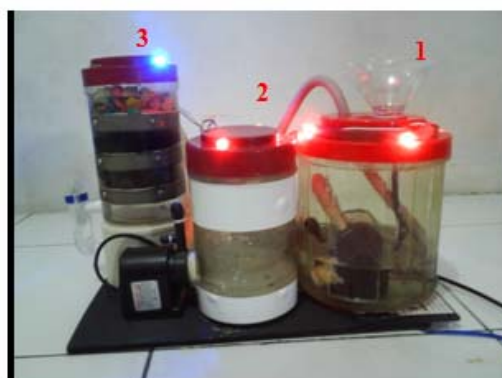
Gambar 5. Sistem pemrosesan limbah medis
