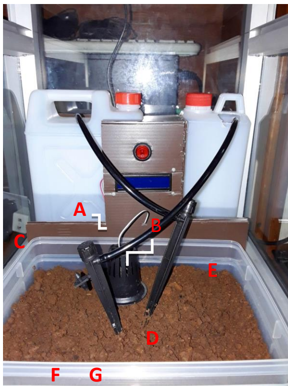
Gambar 10. Prototipe sistem penyiraman dan pemupukan otomatis berbasis IoT
