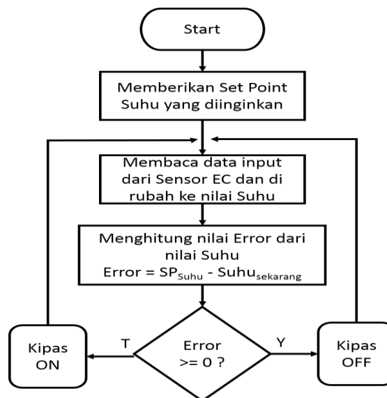
Gambar 5. Diagram alur untuk pengatursuhu air
