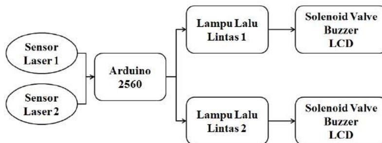
Gambar 1. Diagram Blok Rancangan Alat Pendeteksi Pelanggaran Kendaraan pada Persimpangan Lalu Lintas
