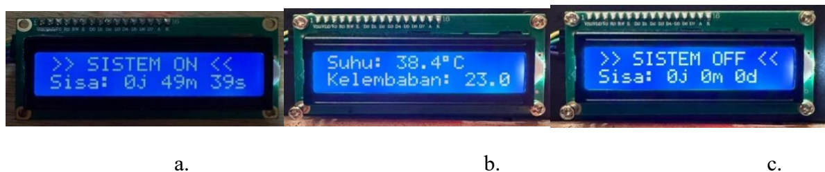
Gambar 8a. Tampilan LCD Ketika Alat Aktif, 8b. Tampilan LCD Suhu dan Kelembaban, 8c. Tampilan LCD Ketika Alat Non Aktif
