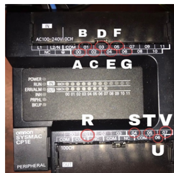
Gambar 7. Titik pengukuran Tegangan
