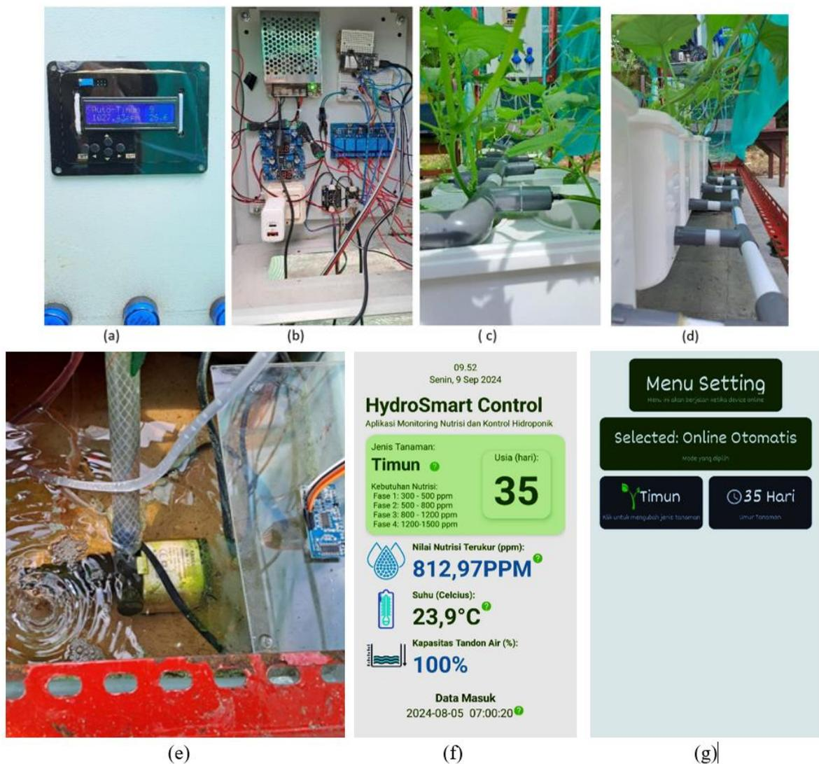
**Gambar 7. Implementasi Sistem (a) Layar LCD, (b) Perangkat Mikrokontroler, (c) Media hidroponik, (d) Pipa Sirkulasi Nutrisi, (e) Tandon Nutrisi, (f) Aplikasi, (g) Pengaturan Sistem Melalui Aplikasi**
