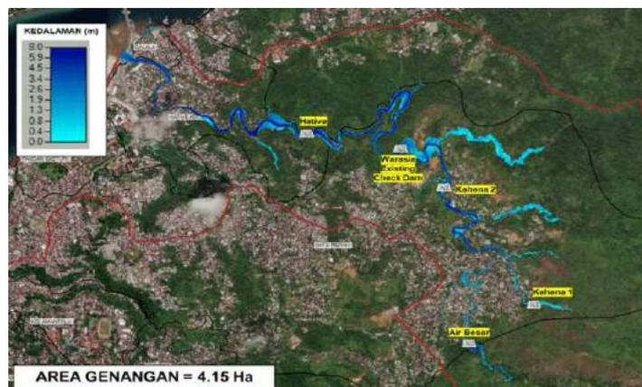
**Gambar 10. Peta Area dan Tinggi Genangan Kondisi Setelah Penanganan Q<sub>25</sub>**
