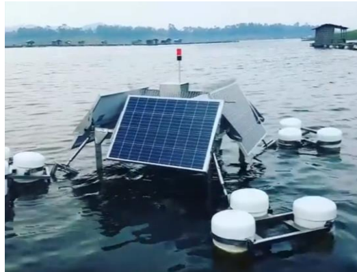
Gambar 10 Ujicoba modifikasi SAV di Waduk Jatiluhur
