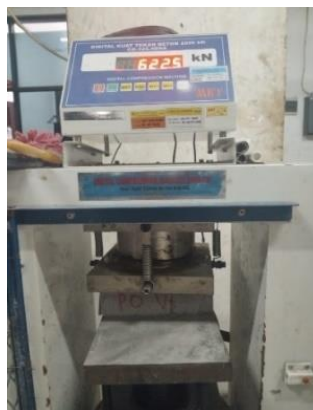
Gambar 3. Pengujian Kuat Tekan Paving Tertinggi Usia 14 Hari
