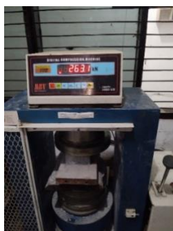
Gambar 2. Pengujian Kuat Tekan Paving Tertinggi Umur Tujuh Hari
