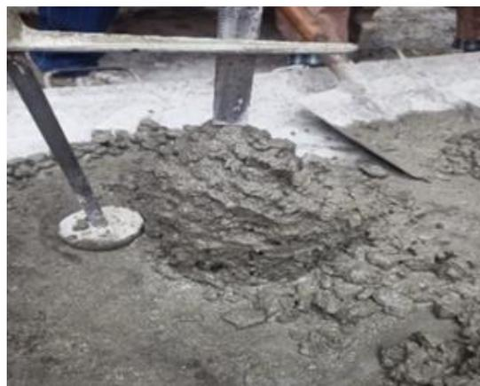
**Gambar 3. Pengujian Nilai *Slump***
