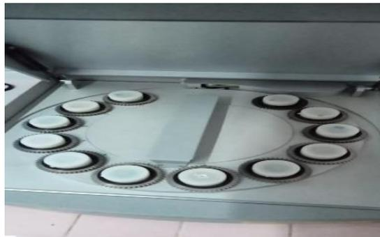
**Gambar 1. Pengujian XRF**
