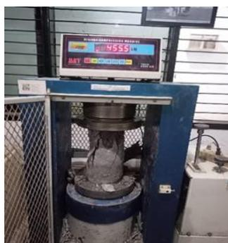
**Gambar 9. Pengujian Kuat Tekan Umur 28 Hari**
