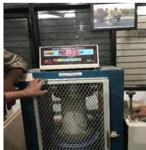
**Gambar 7. Pengujian Kuat Tekan Umur 7 Hari**
