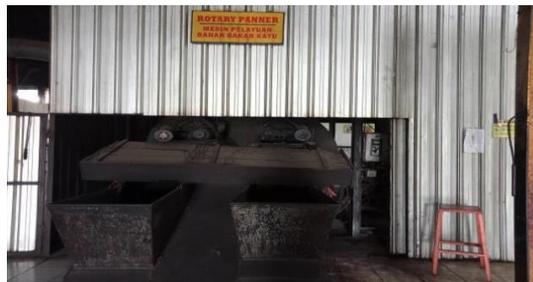
**Gambar 2. Proses Pelayuan Menggunakan Mesin Rotary Panner**
