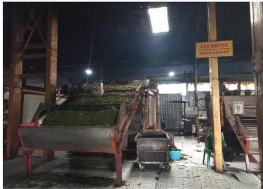
**Gambar 4. Proses Pengeringan Awal Menggunakan Mesin *ECP Dryer***
