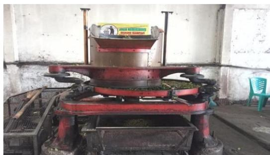
**Gambar 3. Proses Penggulungan Menggunakan Mesin Double Roller**
