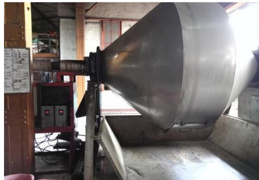
**Gambar 5. Proses Pengeringan Akhir Menggunakan Mesin *Ball Tea***
