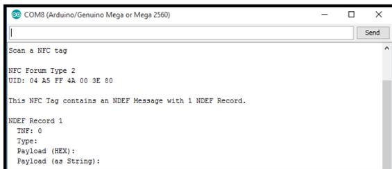
**Gambar 4.2. Pengujian untuk membaca tag NFC kosong dengan NFC Modul Arduino**
