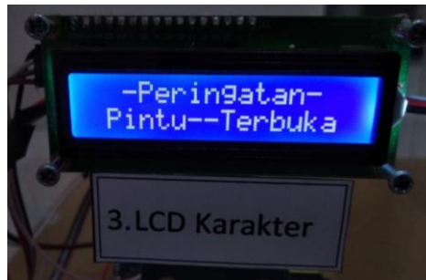
Gambar 12. Tampilan LCD jika Pintu Dibuka secara Paksa
