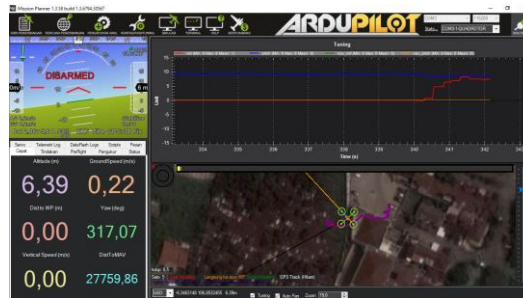
Gambar 17. Pengujian Sensor Acelerometer Secara Miring ke Kiri
