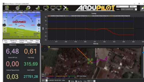
Gambar 16. Pengujian Sensor Acelerometer Secara Miring ke Kanan
