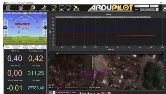
Gambar 19. Pengujian Sensor Acelerometer Bergerak Kebelakang
