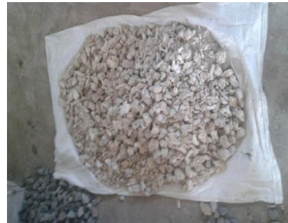
Gambar 2 Batu Karang Pulau Enggano yang sudah dipecahkan sebagai split 2/3 sebagai pengganti agregat kasar
