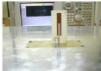
Gambar 15. Pengukuran input Impedansi UHF
