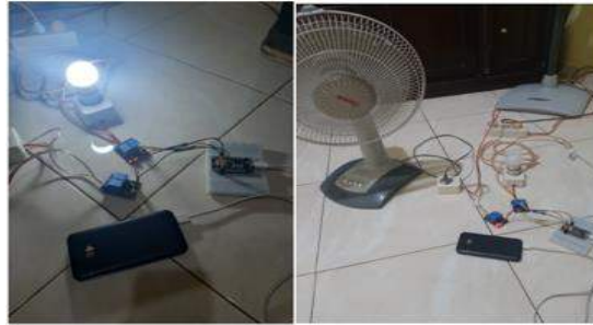
Gambar 7. Rangkaian Smart Home Jika Diberikan Perintah Hidupkan Lampu dan Kipas Angin
