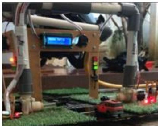
Gambar 4. Kondisi Alat saat Lampu Hijau dengan Mobil Terdeteksi Sensor Laser
