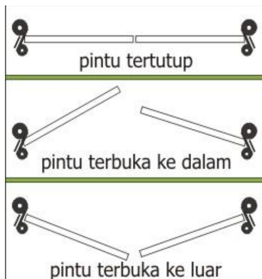
Gambar 15. Sistem pintu kupu pada toilet portabel
