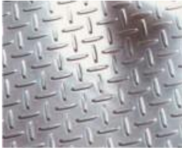
Gambar 14. Material Bordes Stainless Pada Toilet Portabel
