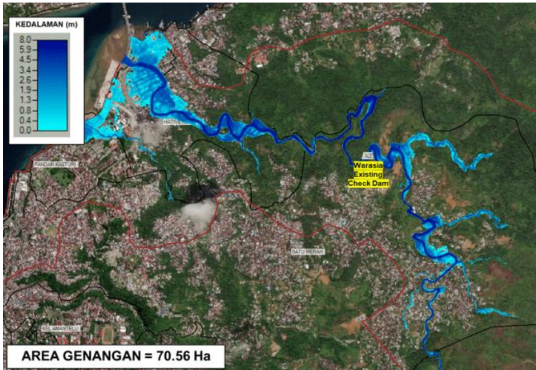
Gambar 8. Peta Area dan Tinggi Genangan Kondisi Tanpa Penanganan Q_{25}
