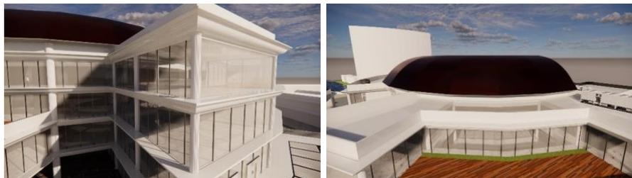
**Gambar 13. Ilustrasi 3D Konsep Penggunaan Aksesoris Ornamen Neoklasik Kolonial Belanda, pada Kolom dan List Atap dengan Material Beton dan Konsep Bangunan *Post-Modern* yang Menunjukkan Penggunaan Atap yang Melengkung Menyerupai Dome dengan Material Metal Cladding**
